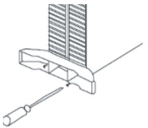
Перед использованием обогревателя опора (поставляемая отдельно в коробке) должна быть прикреплена к прибору. Для крепления опоры к основанию обогревателя используются 4 предоставленных в комплекте самонарезающих винта, при этом необходимо соблюдать осторожность, чтобы обеспечить их правильное расположение в нижней части боковых фасонных планок обогревателя.
